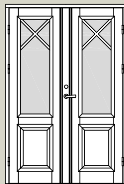
PD22 förslag 112 Spröjs kryss
